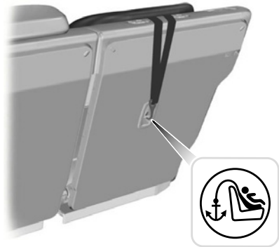
Скоби кріплення верхнього ременя розташовані на спинці заднього сидіння.
